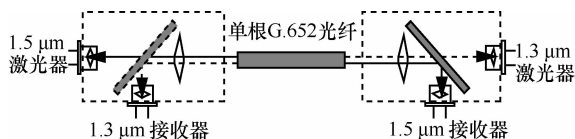
图 1 单纤双向通信原理
